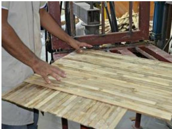
Figura 2: Compensado de bambu. Fonte: G1 globo.com (2014)
