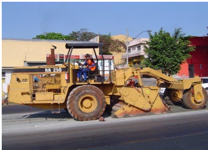
Figura 2 - Recicladora/Estabilizadora Cartepillar RR 250.
