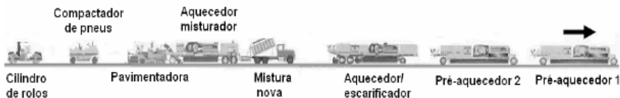
Figura 4 - Fases da reciclagem a quente in situ
