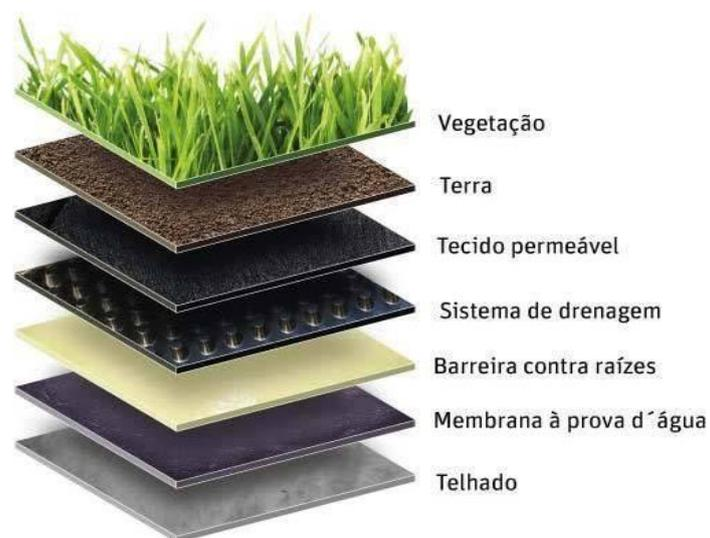
(Ilustração demonstra as etapas e materiais que integram o sistema de telhado verde.)
