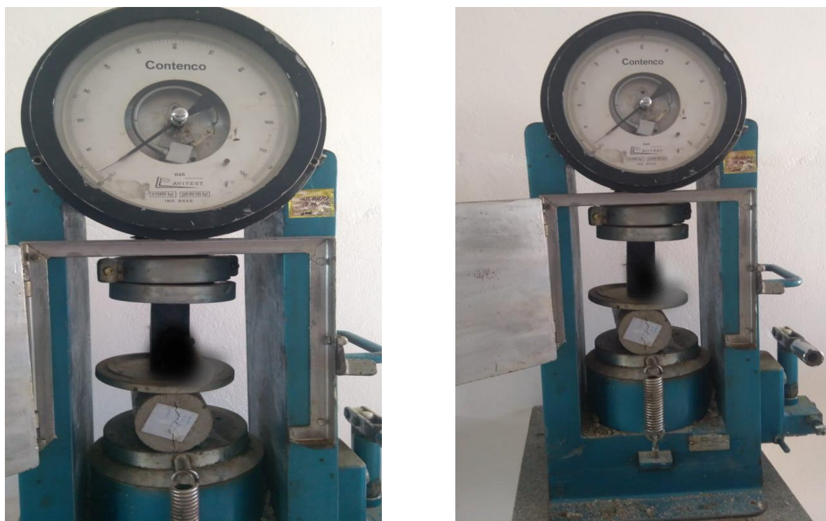
Figura 25: Ruptura a tração por compressão diametral na idade de 3 (três) dias. A direita o concreto usinado e a esquerda o produzido em obra
