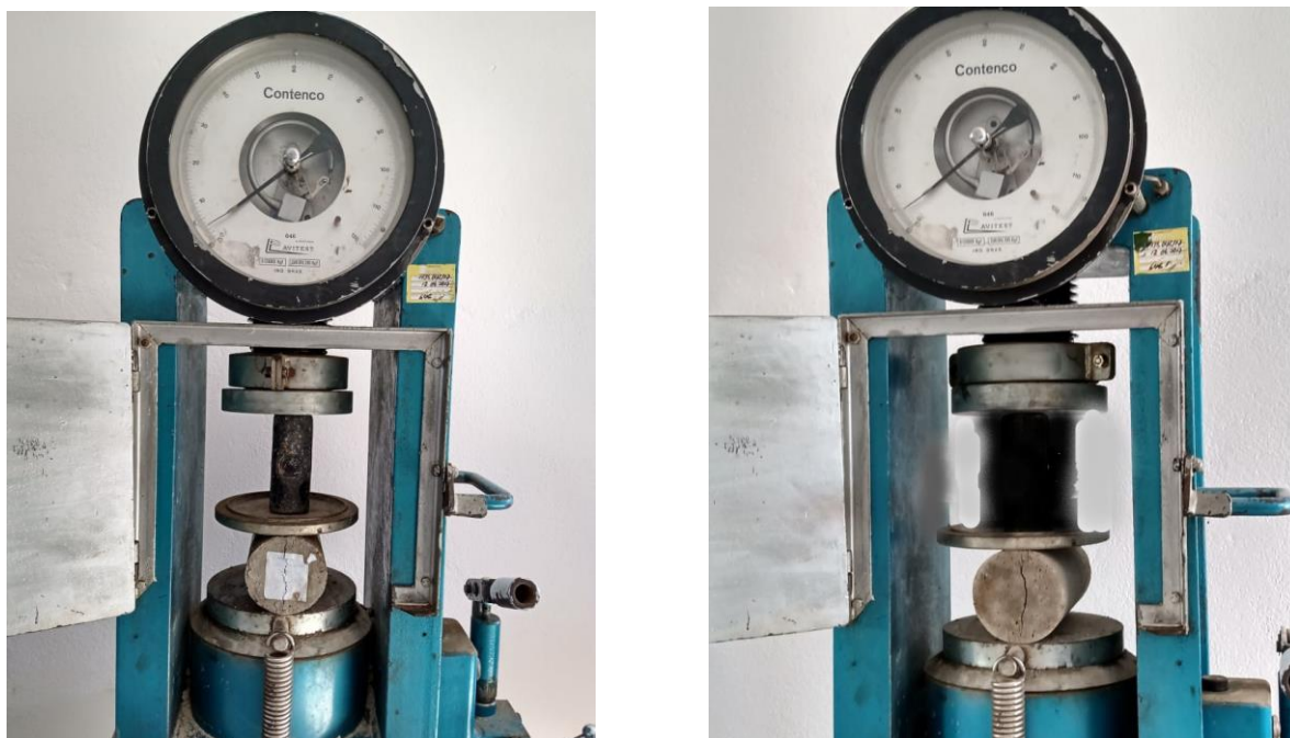
Figura 27: Ruptura a tração por compressão diametral na idade de 7 (sete) dias. A direita o concreto usinado e a esquerda o produzido em obra
