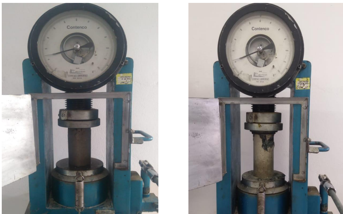
Figura 30: Ruptura a compressão na idade de 28 (vinte e oito) dias. A direita o concreto usinado e a esquerda o produzido em obra
