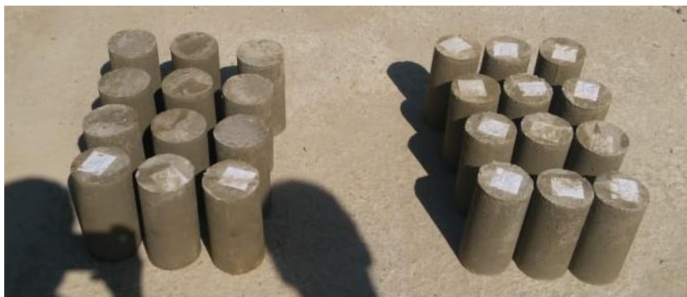
Figura 18: Corpos de prova, deformados. Doze (12) para teste de resistência a compressão e doze(12) para resistência a tração
