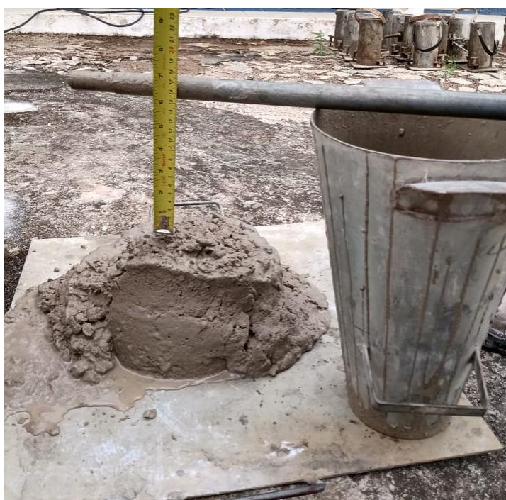
Figura 21: Ensaio de abatimento (Slump Test)
