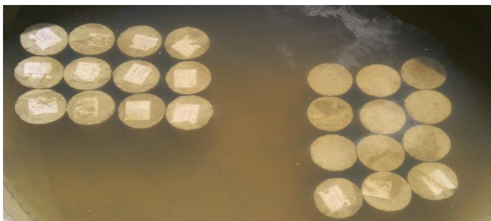
Figura 19: Cura dos corpos de prova (CP's)
