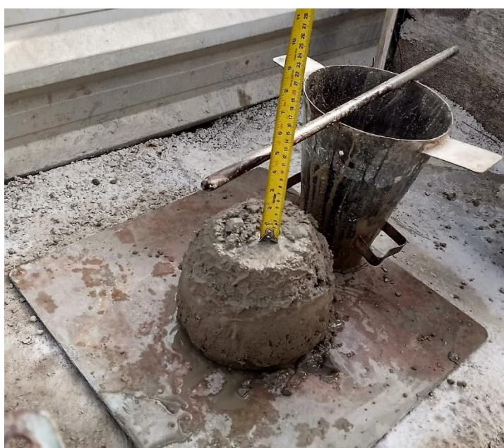
Figura 15: Ensaio de abatimento (Slump Test)
