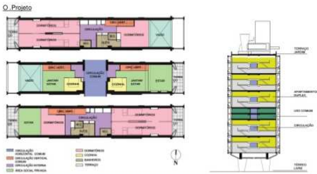
Figura 29 - Plantas e cortes do edifício Marselha. Fonte: Livro conjunto habitacionais do século XX
