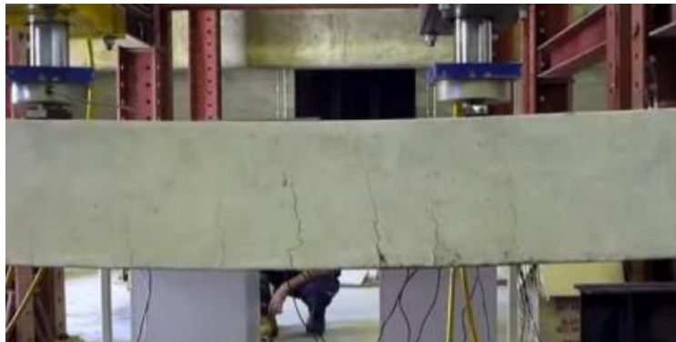
Figura 4 – Fissuras em viga por flexão
