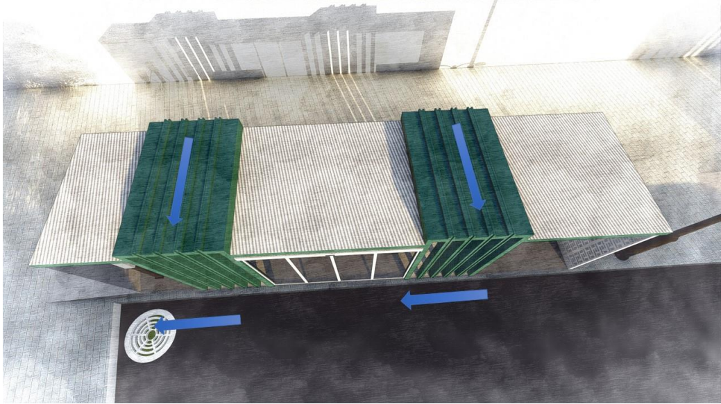
Figura 20 - Cobertura/Esquema do escoamento de água do abrigo
