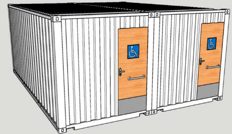
Módulos dos sanitários sendo um feminino e outro masculino, contendo uma cabine para PNE individual em cada módulo. Os containers são do tipo Dry box de 6m
