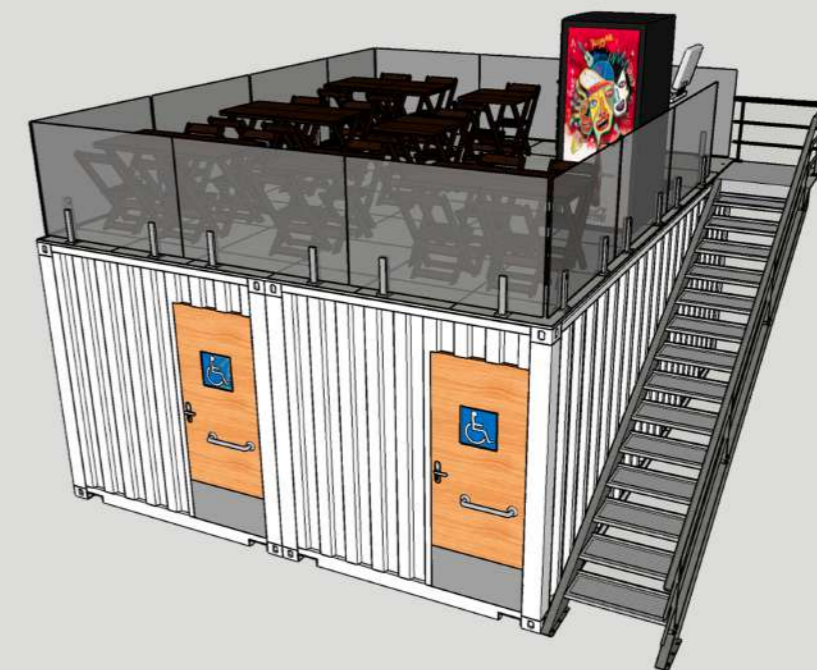
Módulo opcional de área comum, modelo de espaço aberto projetado acima dos sanitários com acesso através de escada
