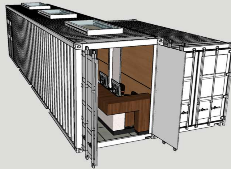
Módulo da área comum e do administrativo, composto por um container Dry box de 12m para a área comum, contendo o salão e os caixas, e outro container também Dry box de 6m para o administrativo
