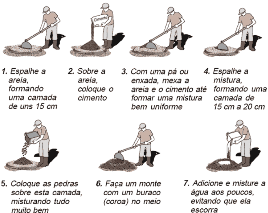
Figura 6 – Passo-a-passo para mistura de concreto. Fonte: www.fazfacil.com.br/reforma-construcao/tracos-concreto-mistura/
