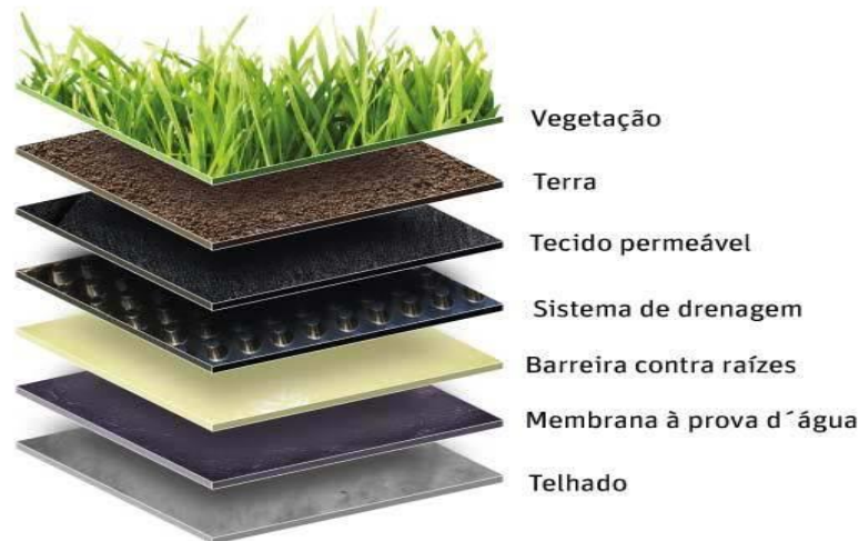
Figura 6- Ilustração de Camadas telhado verde
