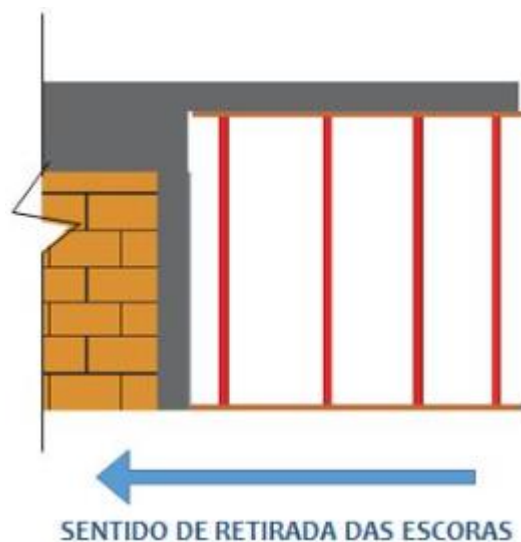
Figura 10: Sentido de retirada de escoras
